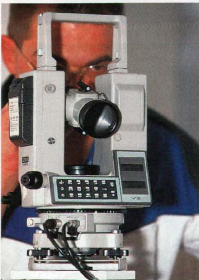
Mit einem Theodoliten werden die Suzuki-Fahrwerke optisch vermessen
