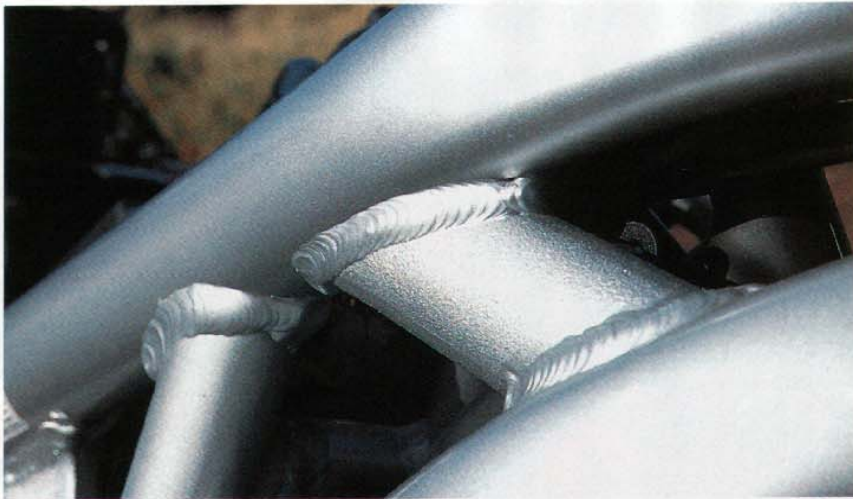
Schön verarbeiteter Leichtmetallrahmen der SV 650 in Fachwerkbauweise
