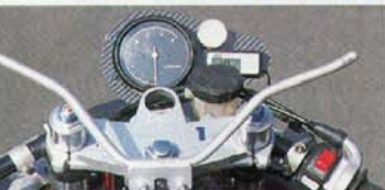
Stark reduziertes Cockpit mit eigengefertigten Verkleidungshalter aus Aluminium. Der riesige Kühler ist im Einsatz Gott sei Dank unter viel gnädigem Plastik versteckt
