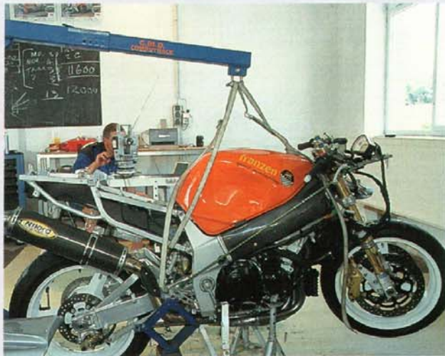
... die mit dem geeichten Theodoliten durchgemessen werden. Dieser erkennt die Drehebene der Räder und die Lenkebene als Referenz
