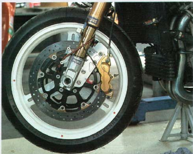
... alle relevanten Messpunkte des Motorrades markiert (die drei roten Punkte). Eine Software gibt beim Vermessen die genaue Reihenfolge vor, ...
